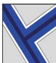
Poziționarea unei garnituri pentru impermeabilizarea și etanșarea elastică a sifoanelor de scurgere (piesa de 300 mm x 300 mm)
